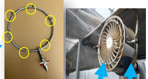
吹出し口前に設置 循環扇
